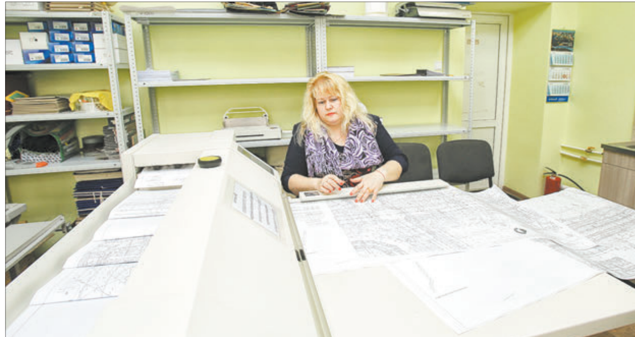
Аператар капіравальна-множыльнай тэхнікі Таццяна Міхайлаўна СМІРНОВА кантралюе работу фолдара, які аўтаматычна складае чарціжы вялікіх фарматаў.
